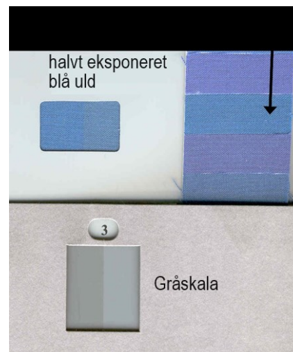
ISO Blå Uld nr. 6 før (til højre) og efter (til venstre) en eksponeringsperiode iht. ISO 105-B06.
